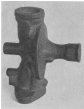
Abb. 4. Vergasergehäuse von Holley. Gewicht 1 kg.
