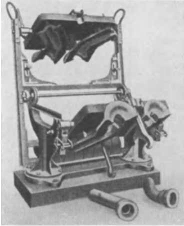
Abb. 12. Gießmaschine von Rolle.
