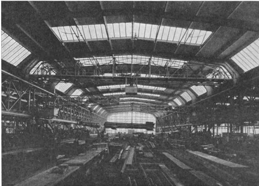
Abb. 171. Laufkran: Tragkraft 15 t,  $s = 27,5$  m. Konsolkrane: Tragkraft 5 t, Ausladung 11 m. Ausführung MAN.
