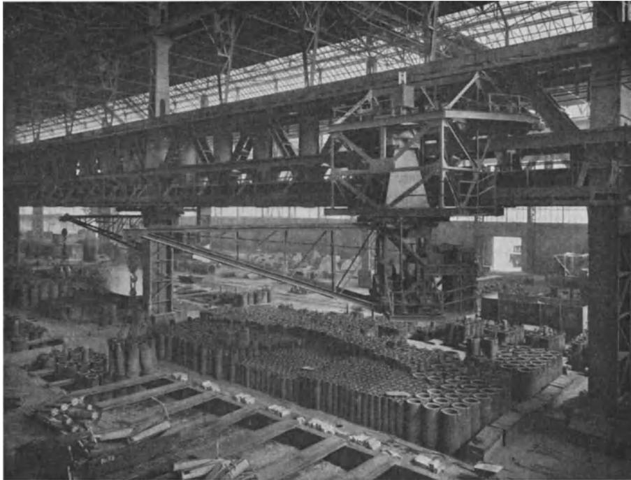
Abb. 192. Konsoldrehkran mit vollem Drehkreis. Ausführung Demag.
