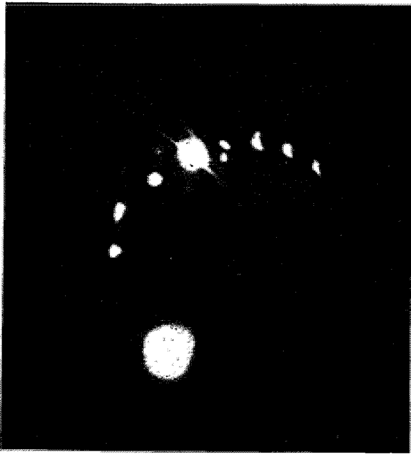
Abb. 13. Reflexionsaufnahme mit 40 kV-Elektronen an (100) von \text{CaCO}_3 .
