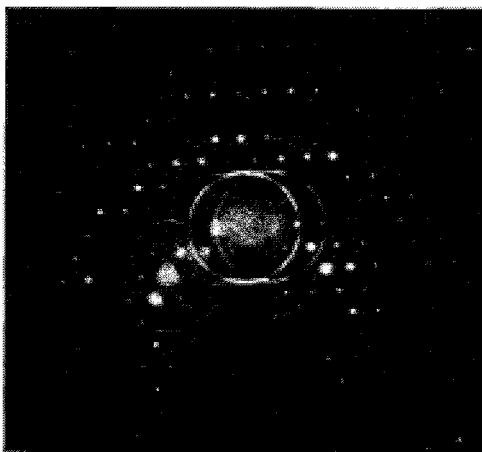
Abb. 35 b. CdJ_2 , Übergangsform zum Einkristallbild (dicke Schicht auf Glimmer, kurze Zeit auf 250^\circ erhitzt).
