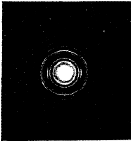
Abb. 34. Kalomel, Schichtebene 45^\circ gegen den Strahl geneigt. (Tetragonale Achse \parallel zur Schicht.)
