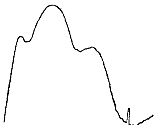
Abb. 45. Photometerkurve einer Streuaufnahme von CCl_4 (BEWILOGUA 6).
