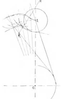
Abb. 7. Vergleich der Anlaufkurven für gleiche Erhebungen bei zentrischer und exzentrischer Geradföhrung der Spindel.
