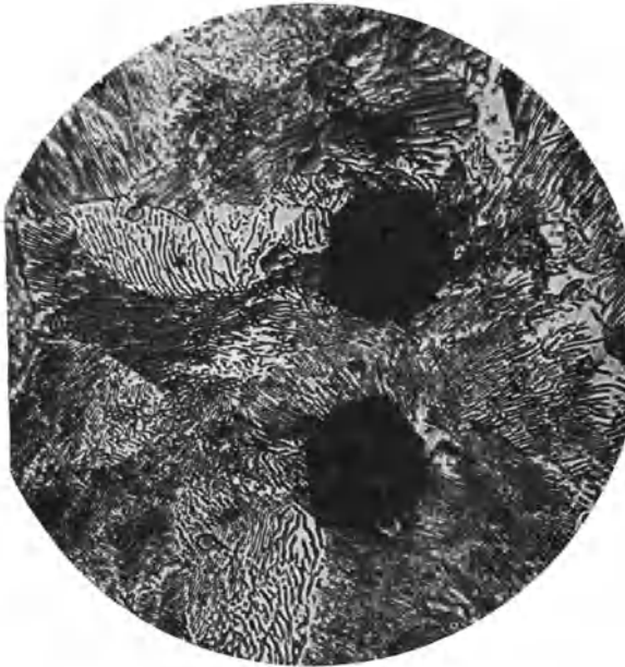
Abb. 317. Kupolofentemperguß in 3 mm Tiefe. ( \times 200 )
