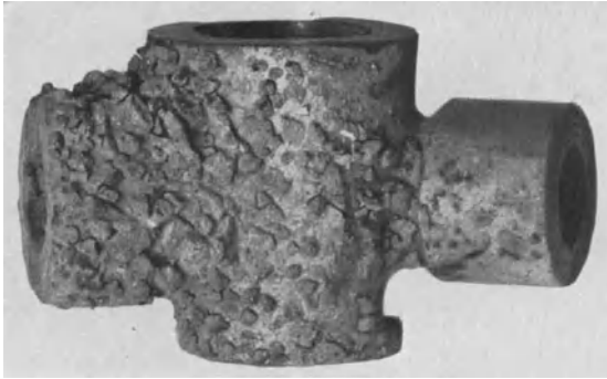
Abb. 96. Temperguß mit eingebranntem Tempererz.
