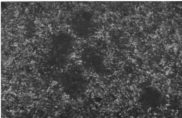
Abb. 111. Schwarzguß (wie Abb. 108) 30 Minuten bei 850^\circ geglüht und an der Luft abgekühlt. ( \times 100 )
