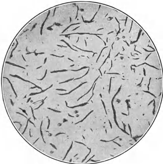
Abb. 304. Kern von geglührtem Grauguß. ( \times 200 )
