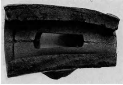
Abb. 14. Gußstück aus Temperguß mit schwarzem Bruch (Schwarzguß).
