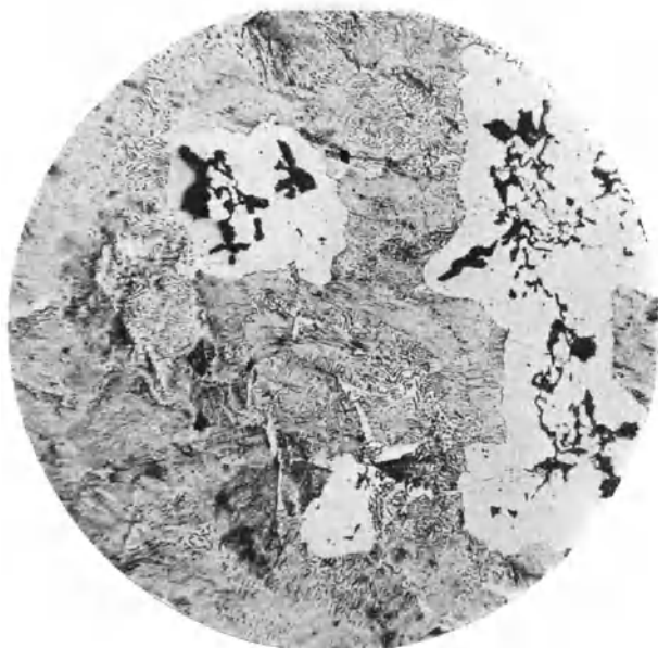
Abb. 320. Schwarzguß, zu rasch abgekühlt. ( \times 100 )
