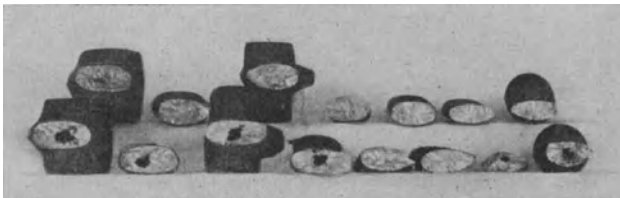
Abb. 194. Bruchstücke des Hebels. Unten Lunkstellen; oben dicht.
