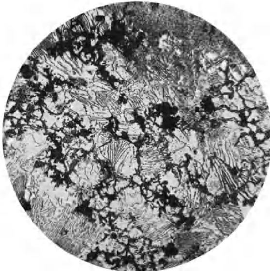
Abb. 310. Graphitnest (geätzt). ( \times 200 )
