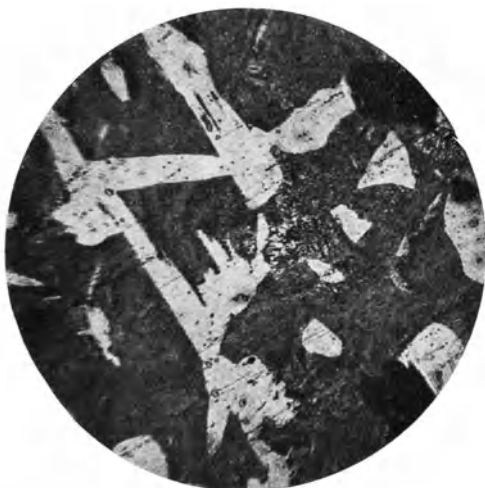
Abb. 315. Überhitzter Temperguß in 1 mm Tiefe. ( \times 100 )
