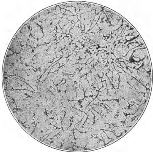
Abb. 305. Oberfläche von geglühtem Grauguß. ( \times 200 )
