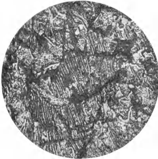
Abb. 307. Geglühfrischer Grauguß im 2 mm Tiefe, geätzt. ( \times 200 )
