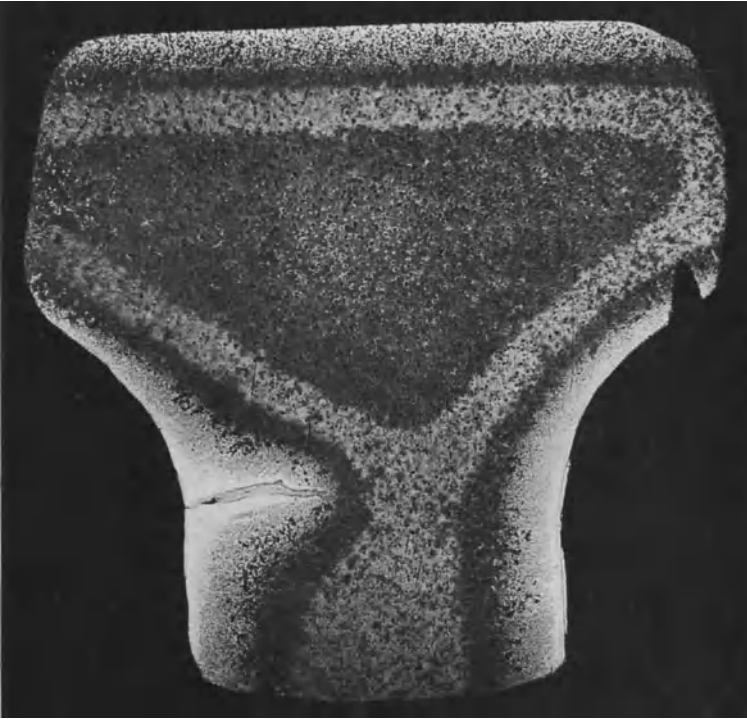
Abb. 93. Querschnitt eines Gußstückes mit mehreren Zonenbildungen. Der Verlauf der Zonen ist durch einen Riß im Rohguß beeinflusst. ( \times 5 )
