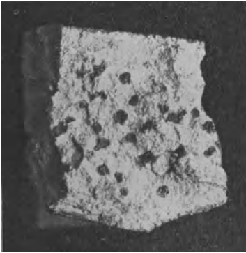
Abb. 308. Natürlicher Bruch von graphit­haltigem Temperrohguß. ( \times 2 )
