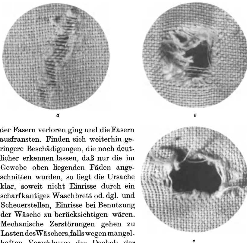
Abb. 58. Fortschreitende Lochbildung eines mechanisch beschädigten Stoffes.
