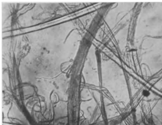
Abb. 33. Leinenfaser durch mechanische Beanspruchung infolge zu kurzer Waschlotten zu stark verschlissen. Aufnahme von Stockhausen & Cie., Krefeld.
