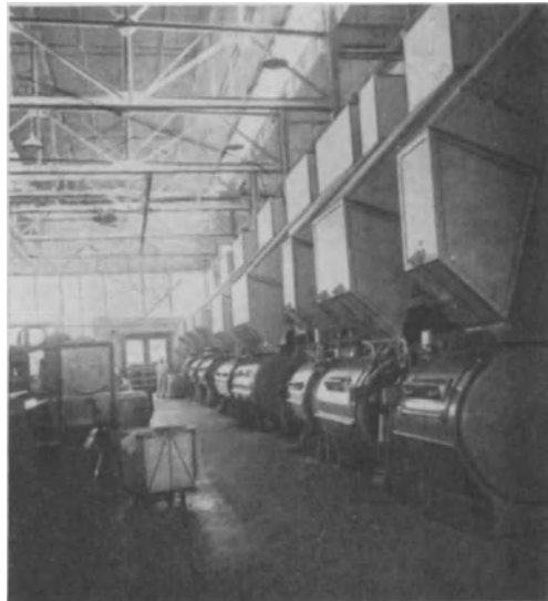
Abb. 28. Wäscherei des amerikanischen Instituts in Joliet. Maschinen mit Wäscheschächten. Die kippbaren Maschinen entleeren die Wäsche in aushebbare Zentrifugenkörbe. Waschmaschinen und Pressen usw. sind in einer Halle ohne Zwischenwände untergebracht. Da nur mit Heißwasser gearbeitet wird, kommt eine starke Wrasenbildung nicht in Frage.
