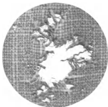
Abb. 21. Gewebebeschädigung durch Chlorkalk. Vergr. 5 \times .
