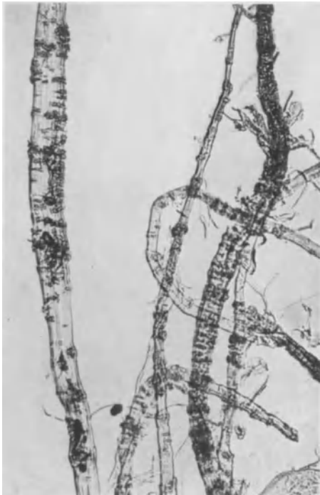
Abb. 64. Vergrößerung von kalkhaltigen Leinenfasern.
