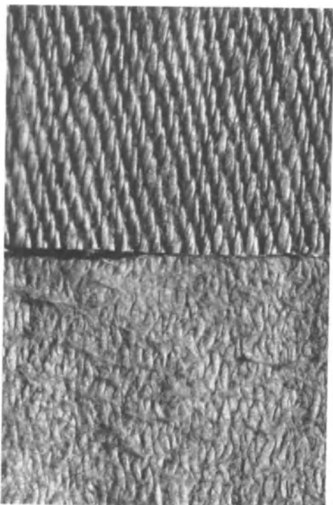
Abb. 62. Körperbindung. a neues Gewebe, b 25 mal mit hartem Wasser gewaschen.
