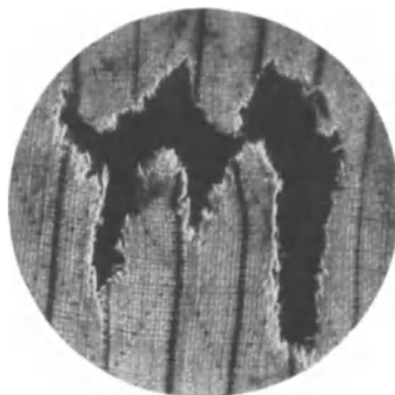
Abb. 68. Gewebeschädigung durch Schwefelsäure. Vergr. 1,3mal.
