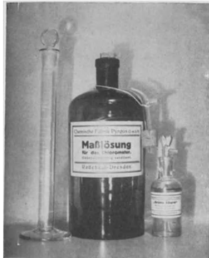
Abb. 53. Chlorometer und Meßlösung der chemischen Fabrik Pyrgos, Radebeul bei Dresden.
