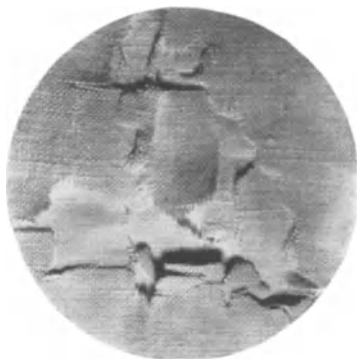
Abb. 67. Gewebeschädigung durch Salzsäure. Vergr. 3mal.
