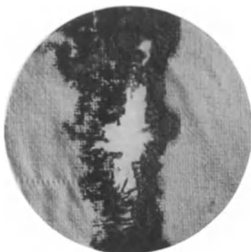
Abb. 5. Gewebsbeschädigung durch Rostflecken. Vergr. 1: 1.
