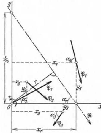
Abb. 27. Beliebige verteilte Kräfte. Lageplan für die rechnerische Behandlung.
