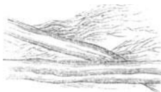
Leinenfaser aus Handgespinnst, an der Oberfläche zerzert. 200mal vergrößert.
