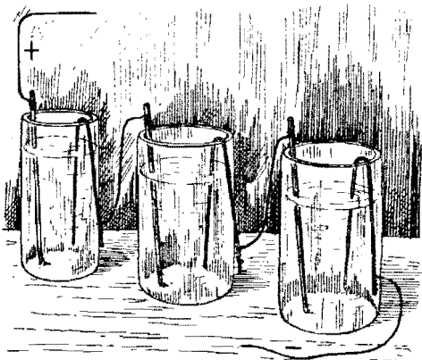
Рис. 21. Три элемента, сделанные из стаканов, карандашей, головных шпилек и раствора соли.
