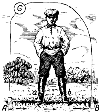
Рис. 11. Если из генератора тока G пропустить ток через землю между пластинами A и B , то, встав между ними, вы почувствуете ток.
