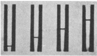
Abb. 12. Wanderung des Tabakmosaikvirus im anodischen Schenkel des TISELIUS-Apparats (TÖPLERSche Schlierenmethode). Feldstärke 5 V/cm. Zeitraum zwischen den Aufnahmen 10 Minuten. PH 7,0.
