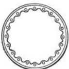
Abb. 353. Filterkorb aus Messing
