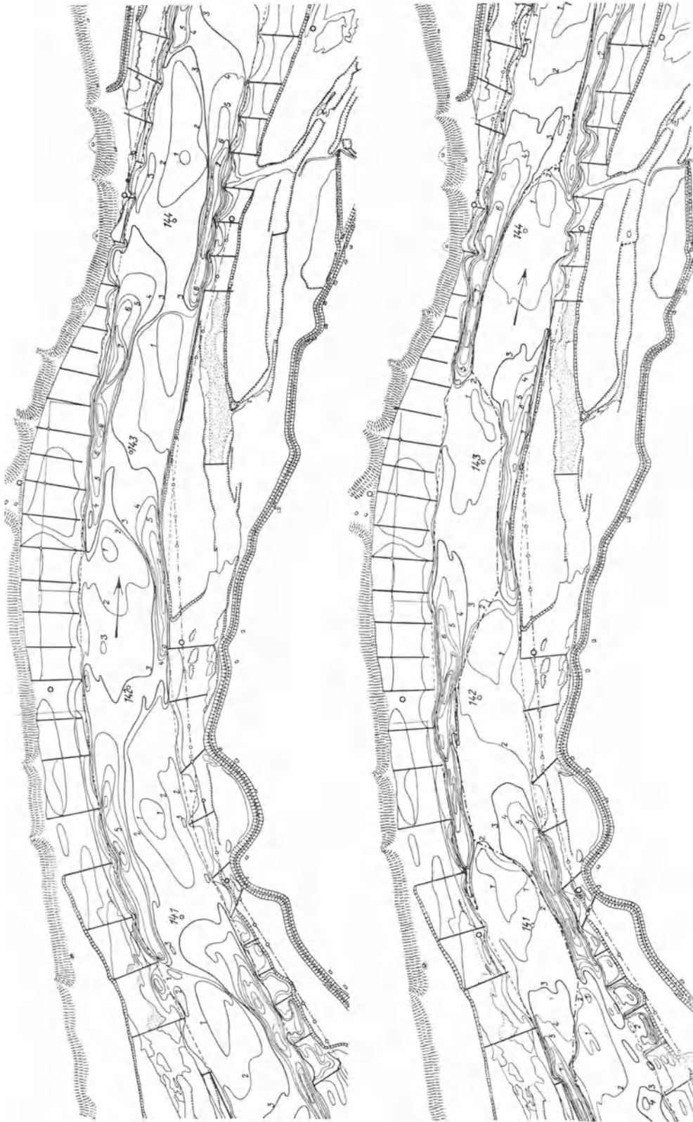
Abb. 167. Das Wandern der Sandbänke in der Weichsel (Nach H. Engels)
