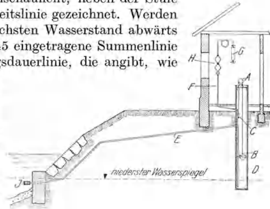
Abb. 47. Verbindung zwischen dem Fluß und dem Schwimmerschacht durch einen Heber. (A. Ott, Kempten)
