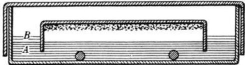
Fig. 16. Doppelschalen für Anaerobenzüchtung nach OGATA-TAKANOUCI. *A* Absorptionsflüssigkeit, *B* flüssiges Paraffin.
