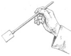
Abb. 52. „Löffel am Bernsteinstiel“, kleiner „Konduktor“ oder „Elektrizitätsträger“.
