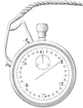
Abb. 39. Diese auf \frac{1}{50} Sekunde ablesbare Stoppuhr schließt einen Stromkreis während der Laufzeit ihres Zeigers. Sie ermöglicht die bequeme Herstellung bekannter Amperesekunden. Ein kaum weniger bequemer Zeitschalter kann leicht mittels eines Grammophonuhrwerkes improvisiert werden.
