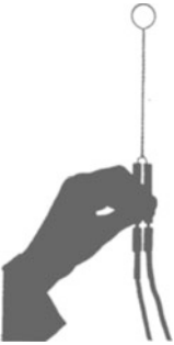
Abb. 183. Probenspule zur Messung der Kraftflußdichte eines Elektromagneten. Eine Windung von 3 \text{ cm}^2 Fläche, also Windungsfläche nF = 3 \cdot 10^{-4} \text{ m}^2 .
