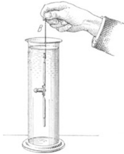
Abb. 463. In destilliertem Wasser hat dieser kürzere Dipol die gleiche Frequenz wie der in Abb. 462 dargestellte 9-mal längere Dipol in Luft. B = Bindfaden.
