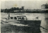
Рис. 44 Глассер с омыаковым двигателем на берегу длина 4 м (13 фута) ширина 1,5 м
