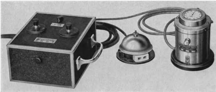
Abb. 9. STRAUSSsche Mekapion. (Aus S. STRAUSS: Der Röntgendosimeter Mekapion, Wien 1930.)
