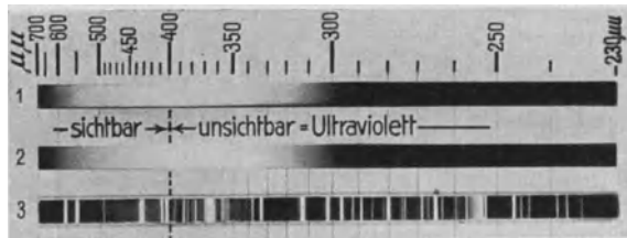
Abb. 1. Spektre: 1 der Sonne, 2 der Kohlenbogenlampe, 3 der Quarzlampe. (Aufnahmen der Quarzlampenges. m. b. H. Hanau.)
