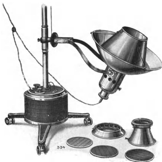
Abb. 71. Große Solluxlampe mit montiertem „großen konischen Reflektoransatz“; daneben liegen der „kleine konische Reflektoransatz“, der Farbglasrahmen und die Farbgläser (Quarzlampenges. m. b. H. Hanau).
