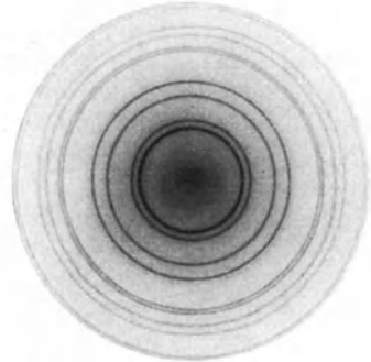
Abb. 534. Beugungsringe von Elektronen beim Durchgang durch eine dünne mikrokristalline Silberfolie. Energie der Elektronen = 3,6 \cdot 10^4 eVolt. Wellenlänge der Elektronen = 6,45 \cdot 10^{-12} m = 0,0645 ÅE. Aufnahme von R. WIERL. Belichtungszeit 0,1 sec.
