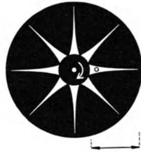
Abb. 544. Rotierende Sektorscheibe zur Änderung des zeitlichen Mittelwertes einer Strahlungsstärke. Mehr als etwa 30 bis 60 Dunkelpausen je Sekunde werden vom Auge nicht mehr wahrgenommen. Der Kreis bedeutet den Querschnitt des Lichtbündels. Ein Schlitten ermöglicht eine seitliche Verschiebung der Sektorscheibe in Richtung des Doppelpfeils.
