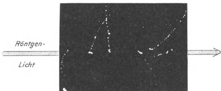
Abb. 407. Nebelkammerbild der lichtelektrischen Wirkung von Röntgenlicht. Mittlere Wellenlänge 0,6 ÅE, entsprechend 2 \cdot 10^4 eVolt. Hier sind nur die Elektronen mit langer Bahnspur zu beachten, die kurzen dicken Bahnschleifen am Anfang der langen dünnen werden erst im § 133 besprochen werden. Aufnahme von P. AUGER.
