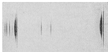
Abb. 245 a. Dopplereffekt im Spektrum von H-Kanalstrahlen. Die scharfen Linien H_{\gamma} und H_{\delta} rühren von ruhenden Atomen her, die links anschließenden breiten von den mit uneinheitlicher Geschwindigkeit bewegten.
