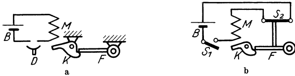
Abb. 3. Arbeitsstromgerät für kurzzeitige Belastung. Fallklappe. a) Betätigung durch Druckknopf. b) Betätigung durch Schalter, Hilfsschalter am Gerät.
