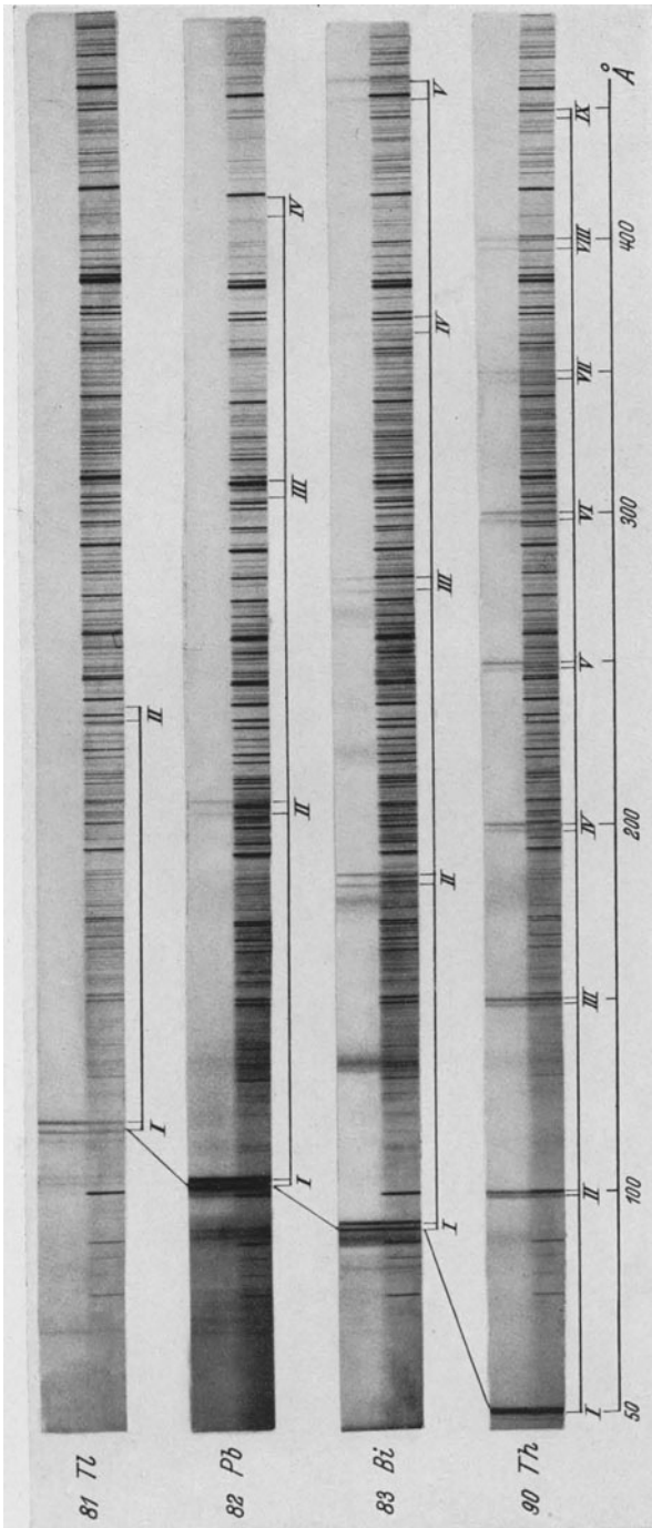
Abb. 20. Die N-Reihe bei den schwersten Elementen. Eine Linie der O-Reihe von 90 Th bei \lambda = 174 \text{ \AA} .
