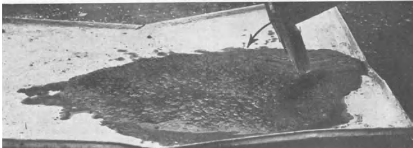
Abb. 10. Gußbetonmischung mit einwandfreier Kornzusammensetzung.
