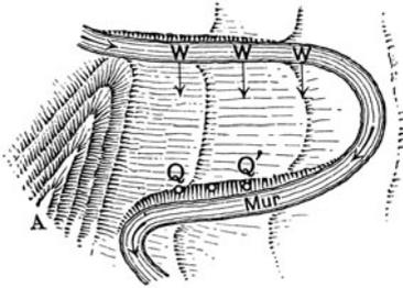
Müller hat sein Werk bedeutend vergrößert und bachabwärts verlegt, den Bach im Gerinne oberhalb von Weißkirchen abgefangen, und unterhalb des Ortes war der Unterwasserabfluß der Turbinen in die alte Bachstatt. In kurzer Zeit nach dem Anlassen dieser Neuanlage sank der Grundwasserspiegel in sämtlichen Hausbrunnen des Ortes. Der Müller leugnete seine Schuld, die jedoch überzeugend damit
