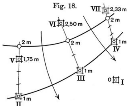
strich 1 m über III, d. i. in 2,00 m Relativhöhe. Aus den Spiegeln IV und VII wird wie früher ebenfalls die relative Höhe 2,00 m bestimmt. Die Verbindung der drei gefundenen Punkte von 2,00 m Höhe gibt die 2 m-Isohypse.
