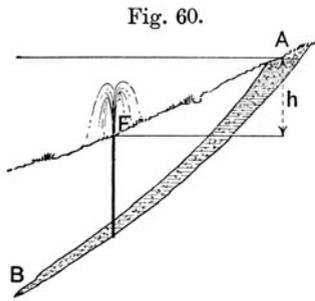
mit Wasser, weshalb dann bei  $A$  kein Wasser mehr eindringen kann und sich eine Sackquelle bildet. Die Wassermasse  $AB$  ist also der allgemeinen Zirkulation entzogen. Wird bei  $F$  ein Bohrloch geteuft, so wird das Wasser wegen des Überdrucks  $h$  als Springbrunnen zutage treten, und zwar anfänglich am höchsten, später niedriger, weil der Wasserspiegel sich unter  $A$  gesenkt hat. Wird dieses
