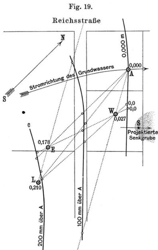
in der Stromrichtung von  $W$  und in dessen Nähe gelegen wäre. Die Senkgrube wurde nach  $S$  gegeben, die Stromrichtung daselbst führt weit ab von  $A$ , so daß auch keine Gefahr ist, daß die Infektionsstoffe von  $S$  durch Diffusion den Brunnen  $A$  erreichen.
