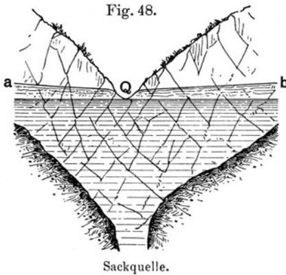
Wasserspiegel bis *a* und *b* erhöhen, infolgedessen ein Wasserauslauf, eine Quelle, am tiefsten Punkt der Oberfläche bei *Q* erfolgen wird.
