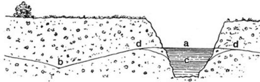
die Fortbewegung im Wasser zerrieben wurden und dadurch ein hydraulisches Material lieferten, mit welchem die Poren des Bachbettes gedichtet wurden. Die Spreesohle bei Berlin ist mittels einer 0,8 m dicken Schlammschicht abgedichtet.
