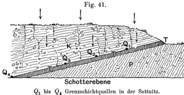
Die Grenzschichtquellen sind um so ergiebiger und die Ergiebigkeit unterliegt weniger Schwankungen, je flacher die Steinscheide liegt; denn dadurch wird das Fanggebiet größer und der Ablauf findet langsamer, somit in einem größeren Zeitraum gleichmäßiger statt.
