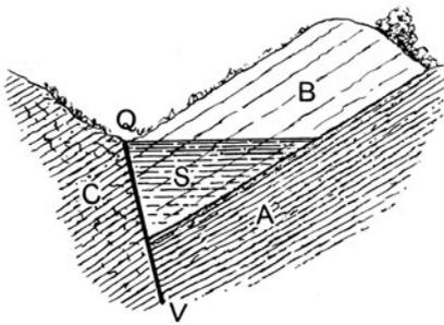
*Q* = Sackquelle, *A* und *C* = wasserdichte Gesteine, *B* = wasserführend, *S* = Wassersack, *V* = Verwerfer (Sprung).
