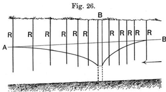
Viele um den Brunnen befindliche Beobachtungsrohre  $R$  (Bohrungen oder Nortonbrunnen), in der Quer- und Längsrichtung des Grundwasserstromes geschlagen, gestatten die genaue Bestimmung der Vertikalschnitte des Senktrichters. Es empfiehlt sich, die Beobachtungsrohre od. dgl. möglichst tief zu treiben, da im Untergrund Grundgebirgsrücken in den Wasserträger hinaufzugen können, durch welche die seitliche bzw. ganze Entwicklung des Senktrichters behindert wird.
