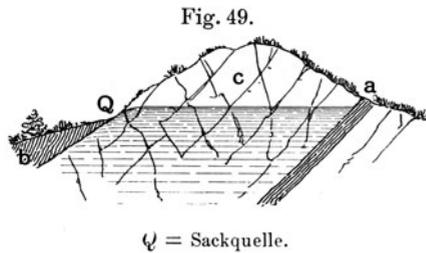
Ein anderes Beispiel einer Sackquelle ist in Fig. 49 erläutert. *a* und *b* sind wasserdichte Schichten, *b* z. B. ein Lehmlager, und *c* ist ein wasserlassendes Gestein, welches in der Tiefe irgendwie derart abgeschlossen ist, daß es gar keinen oder keinen genügenden Wasser-
