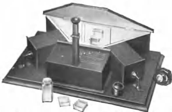
Abb. 12. Tintometer mit Beleuchtungsvorrichtung (Modell der The Tintometer Ltd. ).
