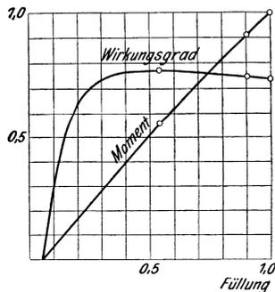
Fig. 236. Überfülltes Löffelrad.
