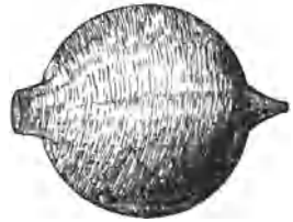
Abb. 217. Resonator nach HELMHOLTZ.
