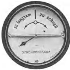
Abb. 190. Synchronoskop.
