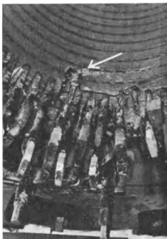
Abb. 323. Wicklungszerstörung durch Körperschluß (Erdschluß).
