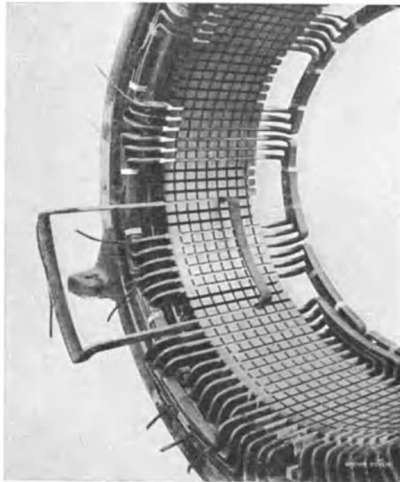
Abb. 135. Eingeschobene Spulenwicklung für 6 kV; halbgeschlossene Nuten.
