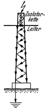
Abb. 334. Unmittelbarer Blitzschlag in einen Leitungsmast.
