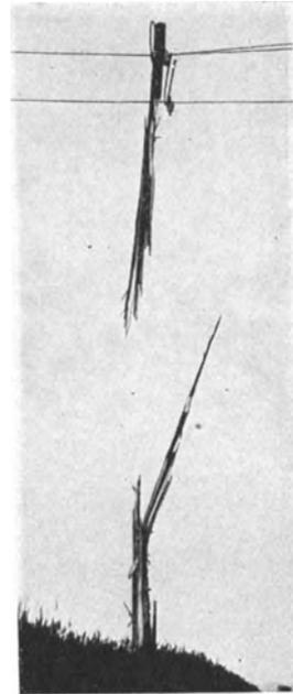
Abb. 335. Durch unmittelbaren Blitzschlag zerstörter Holzmast.
