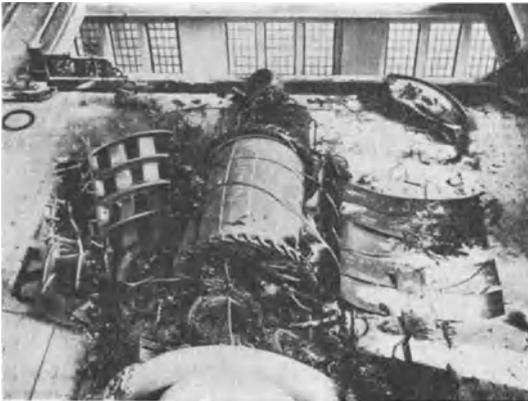
Abb. 324. Infolge Erdschlusses zerstörte Maschine.
