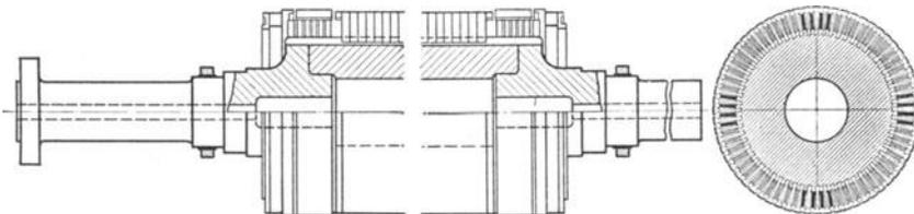
Abb. 148. Läufer eines Turbostromerzeugers, dreiteilig (Trommel und seitlich eingesetzte Wellenstummel), mit offenen Nuten und Längsbelüftung der Erregerwicklung (AEG).
