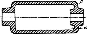
Abb. 124. Falsch. (Gefahr der Kernverlagerung!)
