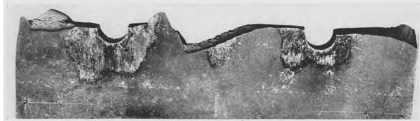
Abb. 65. Bruchstück einer dreireihigen Nietverbindung aus St 52 nach 144 570 Lastwechseln zwischen + 16 und -16 kg/mm 2 .
