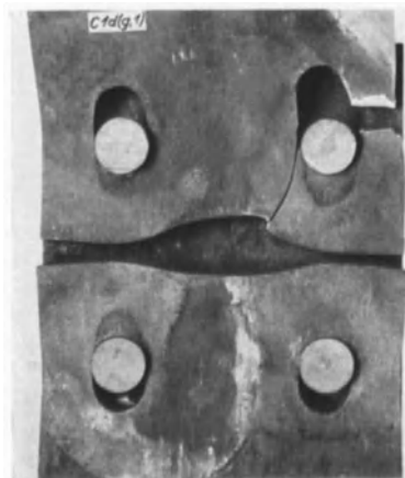
Abb. 12. Nietverbindung der Reihe C1d (Bleche aus St Si, Niete aus St Si) nach dem Zerreiversuch. Eine Lasche ist abgenommen.
