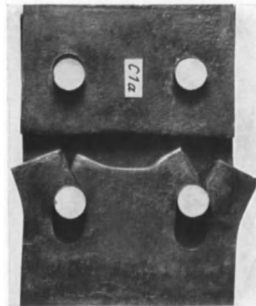
Abb. 11. Nietverbindung der Reihe C1a (Bleche aus St 37, Niete aus St 34) nach dem Zerreiversuch. Eine Lasche abgenommen.
