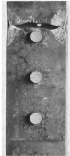
Abb. 33. Dreireihige Nietverbindung aus St 37 nach 1 786 400 Lastwechseln zwischen \sigma = 0,5 und 22,7 kg/mm 2 (Nietköpfe abgeholt, eine Lasche beseitigt).
