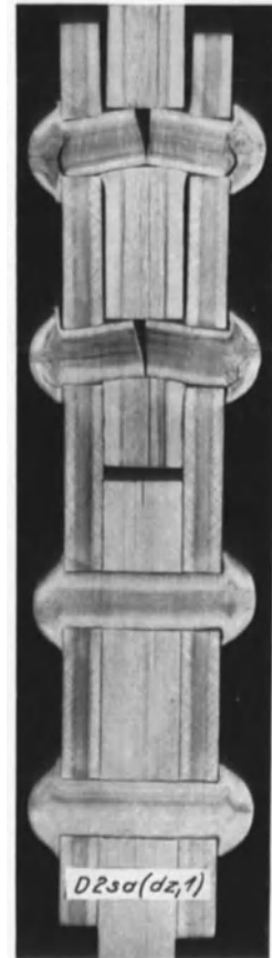
Abb. 43. Nietverbindung der Reihe D2sa nach Spalte 2 der Zusammenstellung 2. Zustand nach 22 228 Lastwechseln zwischen \sigma_u = 0,15 kg/mm 2 und \sigma = 21,4 kg/mm 2 ( \sigma_l = 28,9 kg/mm 2 , \tau = 25,0 kg/mm 2 ).
