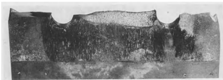
Abb. 64. Bruchstück einer zweireihigen Nietverbindung aus St 52 nach 220 090 Lastwechseln zwischen +15 und -15 kg/mm 2 .
