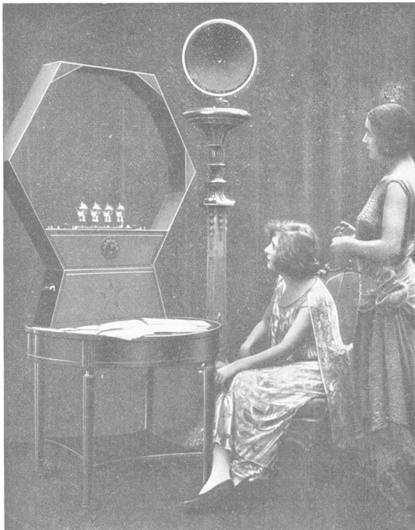
Abb. 90. Vier-Röhren-Rahmenempfänger, Type „Radiola“ der Société Française Radio-Électrique, Paris.
