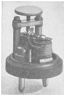
Abb. 291. Summer mit nahezu geschlossenem Eisenweg von G. Seibt.
