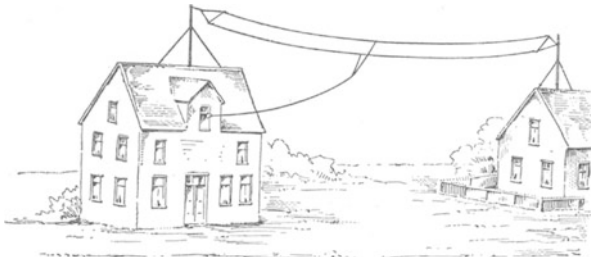
Abb. 130. Richtige Anordnung und Ableitung einer T-Antenne.
