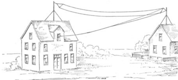
Abb. 131. Ungünstige Anordnung einer L-Antenne.
