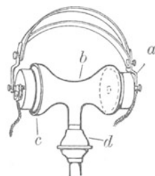
Abb. 163. Rohr-T-Stück mit einem Doppelkopftelephon verbunden.
