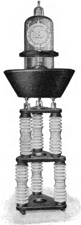
Abb. 68. Elektrostatisches Hochspannungsvoltmeter von S. & H.
