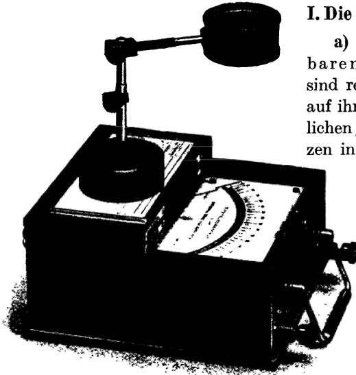
Abb. 3. Tragbares Präzisions-Amperemeter von H. & B.
