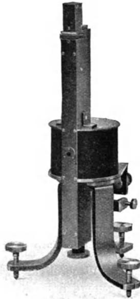
Abb. 296. Vibrations-Spulengalvanometer.
