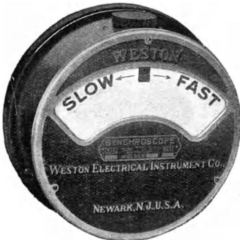
Abb. 227. Synchronoskop der Weston Comp.
