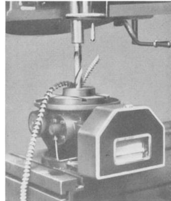
Abb. 132. Versuchsbohr Tisch von Losenhausen bis 10 t/250 mkg.
