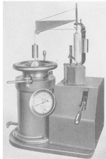
Abb. 83. OLSEN-Tiefungsprüfmaschine.
