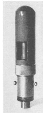
Abb. 14. Technisches Zählrohr für Wanddickenmessung (Bauart Reichs-Röntgenstelle).
