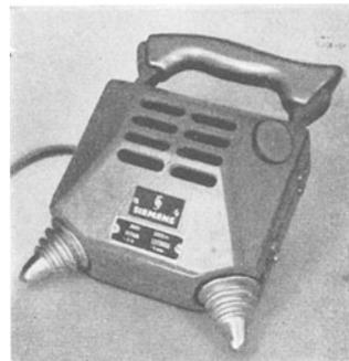
Abb. 42. Handmagnet zum Prüfen von Schweißnähten (300 A). (Hersteller: Siemens u. Halske AG., Berlin-Siemensstadt.)
