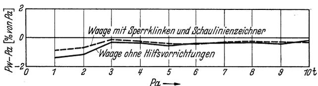
Abb. 57a. Fehlerkurven einer stehenden 10 t-Universal-Prüfmaschine mit Neigungswaage. Fehlerkurven nach Beendigung der Untersuchung.
