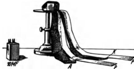
Abb. 95. Links ein zusammengesetzter, rechts ein teilweise auseinander gewickelter technischer Papierkondensator von 10 Mikrofarad Kapazität. Die beiden Stanniolstreifen haben je rund  $4 \text{ m}^2$  Fläche. Ihr Abstand oder die Dicke der Papierstreifen *P* beträgt rund 0,02 mm.
