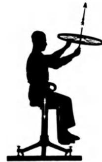
Abb. 157. Zur Erhaltung des Drehimpulses.
