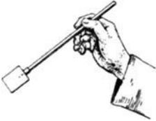
Abb. 52. „Löffel am Bernsteinstiel“, kleiner „Kondensator“ oder „Elektrizitätsträger“.
