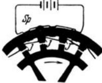
Abb. 246. Wechselstrom-generator mit Zahnradläufer.
