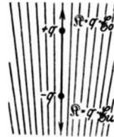
Abb. 113. Ein elektrischer Dipol im inhomogenen elektrischen Felde. Feldrichtung von unten nach oben.
