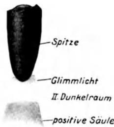
Abb. 335. Der Spitzenstrom in Zimmerluft bei mikroskopischer Beobachtung.
