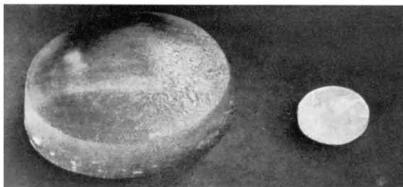
Abb. 43. Beispiel einer Quellung. (Nach STAUDINGER: Zur Entwicklung der Chemie der Hochpolymeren.)
