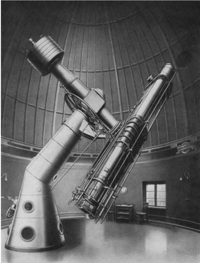
Abb. 7. Photographischer Refraktor (TÖPFER-BAMBERG; Askaniawerke), Sternwarte Berlin-Babelsberg. Die Stundenachse (Polachse) ruht in der geknickten Säule. Die dazu senkrechte Deklinationsachse trägt auf der einen Seite Leitfernrohr und photographische Kamera in einem Mantel (Kassette am unteren Ende), auf der anderen Seite das Gegengewicht.
