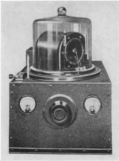
Abb. 16. Quarzuhr nach MARRISON. Thermostat und Oszillator von außen.
