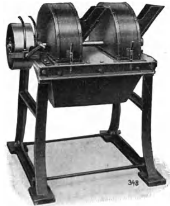
Abb. 108. Doppelter Spannhobel für Maschinenantrieb.
