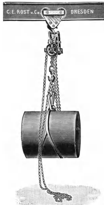
Abb. 93. Vorrichtung zum Auflösen der Trommelsoda.
