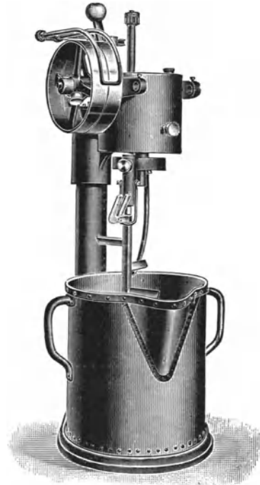
Abb. 88. Rührgefäß mit mechanischem Rührwerk.
