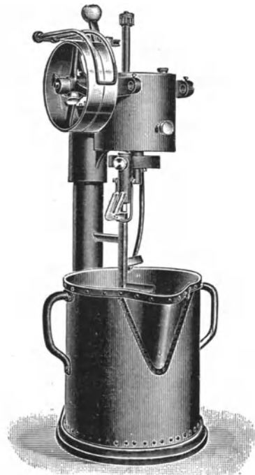
Abb. 135. Rührgefäß für kaltgerührte Seifen mit mechanischem Rührwerk.
