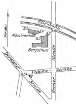
Fig. 156. Handzeichnung zum Beispiel des Festpunktnivellements.
