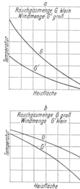
Fig. 139. Abhängigkeit des Gastemperaturverlaufes von der Größe der Gasmengen.
