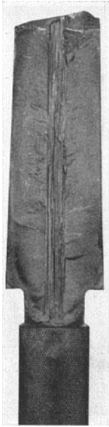
Abb. 159. Bruchaussehen eines Werkzeuges aus lunkerigem Stahl.
