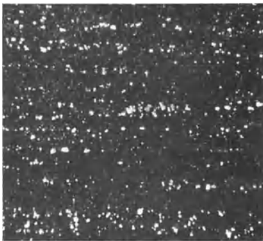
Abb. 131. Schnellstahlkarbide nach 300facher Streckung im Längsschliff. \times 200 .
