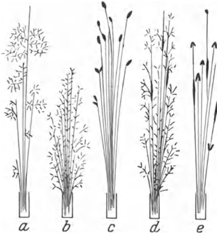
Abb. 156. Funkenbilder verschiedener Stähle. a Manganstahl: weiße Funken; b Harter Kohlenstoffstahl: weiße Funken; c Schnellstahl: dunkelrote Funken; d Mittelharter Kohlenstoffstahl: weiße Funken; e Weicher Kohlenstoffstahl: weiße Funken.
