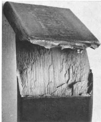
Abb. 153. Bruchaussehen eines Manganfederstahles.
