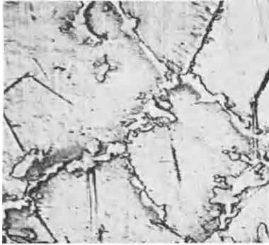
Abb. 43. Kleingefüge rohen, normal abgekühlten hochprozentigen Manganstahles. × 200.
