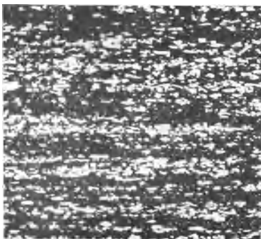
Abb. 54. Kleingefüge eines Stahles mit 2 vH C und 12 vH Cr nach starker Verschmiedung (Längsschliff). \times 200 .
