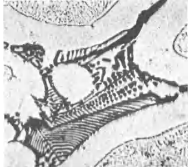
Abb. 127. Kleingefüge von Schnellstahl im Gußzustande. Natriumpikrat. \times 500 .
