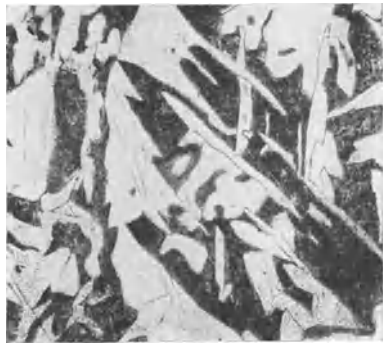
Abb. 11. Stahlguß mit 0,26 C in ungeglühtem Zustande.
