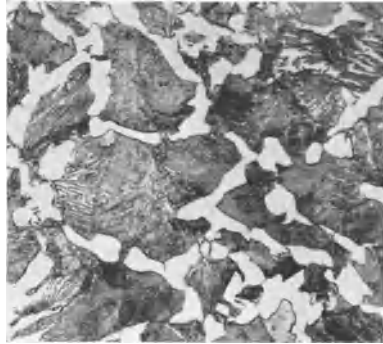
Abb. 3. Kohlenstoffstahl mit etwa 0,5 vH C, Schmiedezustand, Ferrit- und Perlitgefüge. V = 200 .
