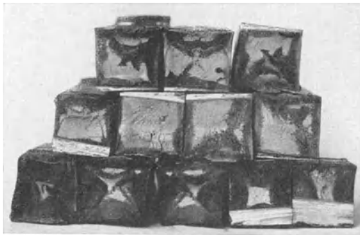
Abb. 163. Beispiele von Schwarzbruchformen mit normalem Stern. \frac{1}{2} nat. Größe.
