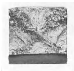
Abb. 34. Grobes Rekristallisationskreuz bei einem ferritischen Chromstahl. Nat. Größe.
