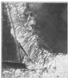
Abb. 149c. v = 120 m/min. \times 10 .
