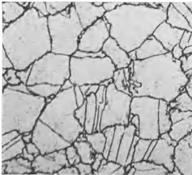
Abb. 108. Rostfreier Chrom-Nickelstahl im Walzzustand. \times 500 .
