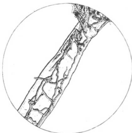
Fig. 72. Holzzellstofffaser aus einem Pilzfleck herauspräpariert.
