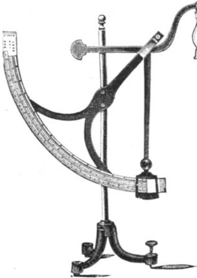
Fig. 25. Wage zur Bestimmung des Quadratmetergewichtes mit Hilfe von 5 Bogen.
