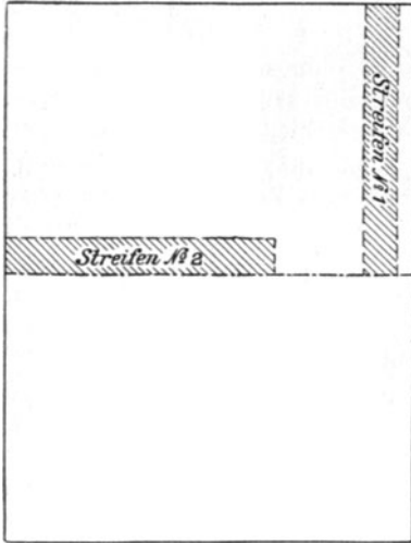
Fig. 3. Entnahme der Probestreifen.
