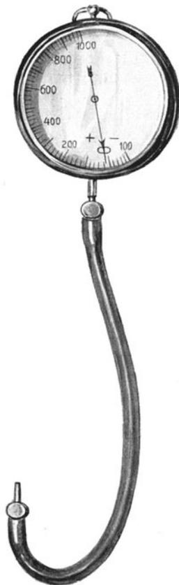
Abb. 19. Manometer zur Feststellung der Druckschwankungen im Duralsack.
