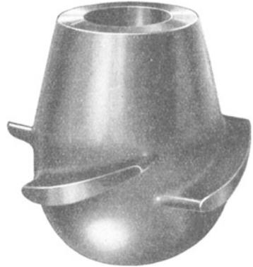
Abb. 161. Bohrlochpropeller für kleine flache Bohrlöcher.
