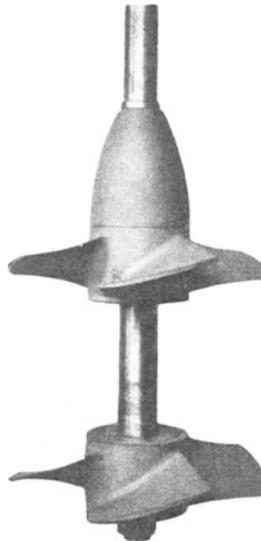
Abb. 171. Läufer einer zwei-stufigen Propellerpumpe.
