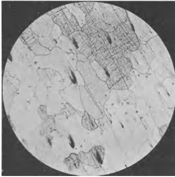
Abb. 7. Fe-Blech mit 2,5% Si; 10% gewalzt; bei 500° C im Vakuum geglüht; v = 50 \times .
