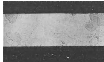
Abb. 14. Fe-Blech mit 2,5% Si; 10% gewalzt; 4 Std. unter H_2 auf 1000° C erhitzt; v = 7 \times .
