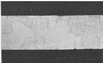
Abb. 13. Fe-Blech mit 2,5% Si; 10% gewalzt; 4 Std. unter H_2 auf 1000° C erhitzt; v = 7 \times .
