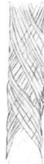
Abb. 58. Verpilzte Baumwolle; die Kutikula ist vollends abgefallen, die Zwischensubstanz aufgezehrt, nur die Spiralfäserchen sind übriggeblieben. ( 580 / 1 )
