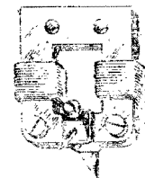
Рис. 151. Звуковая обмотка и якорь рекордера.
