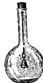
Рис. 53. Прибор для доказательства малой звукопроводности паров ничтожной плотности.
