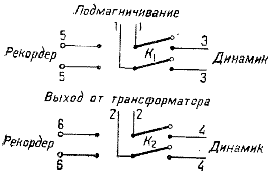
Рис. 130. Схема устройства переключателя.
