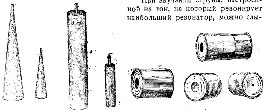
Рис. 78. Резонаторы из консервных банок. Рис. 79. Резонатор с современной собственной частотой.
