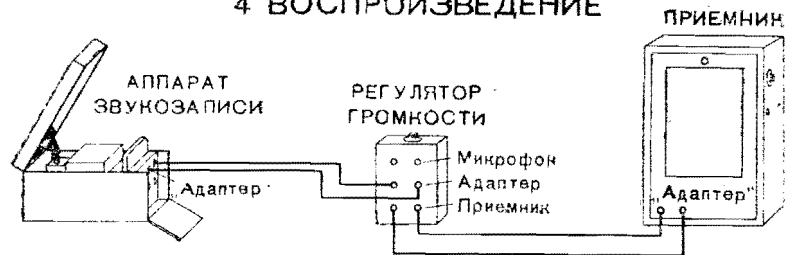
Рис. 156. Основные схемы включения шорнофона.
