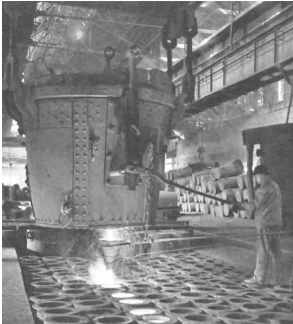
Abb. 47. Kokillenguß im Siemens-Martin-Stahlwerk (Bochumer Verein für Gußstahlfabrikation A.-G.).
