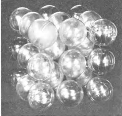
Abb. 1. Atomhaufwerk. Beispiel einer Anordnungsmöglichkeit von Atomen zueinander. Bei dieser Darstellungsweise sind hintereinanderliegende Atomkugeln teilweise oder ganz verdeckt.
