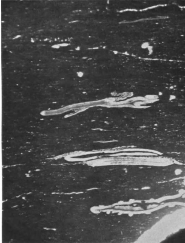
Abb. 45. Dünnschliff durch eine Steinkohle von Zeche Baldur (Ruhrrevier); Durit mit großen und zahllosen kleinen Sporen. Die Sporen sind flach zusammengesunken und erscheinen daher hier im Querschliff (senkrecht zur Schichtung) linsen-linienförmig. ( $\frac{1}{1}$ .)
