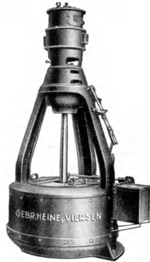
Abb. 115. Pendelzentrifuge im Dreisäulenständer mit Schwingungsdämpfung. Antrieb durch direkt gekuppelten Motor. (Gebr. Heine, Viersen i. Rheinland.)
