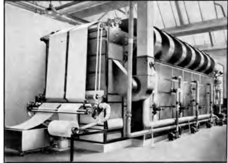
Abb. 169. Hängetrockner für Trikotschlauchware oder auch für 2 bzw. 3 Warenbahnen nebeneinander. (Ernst Geßner, A.-G., Aue.)
