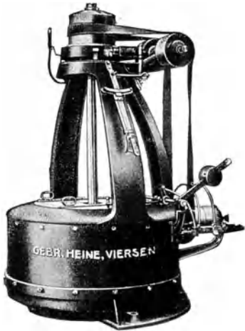
Abb. 114. Pendelzentrifuge im Dreisäulenständer mit Schwingungslämpfung. Antrieb von seitlich liegendem Vorgelege. (Gebr. Heine, Viersen i. Rheinland.)
