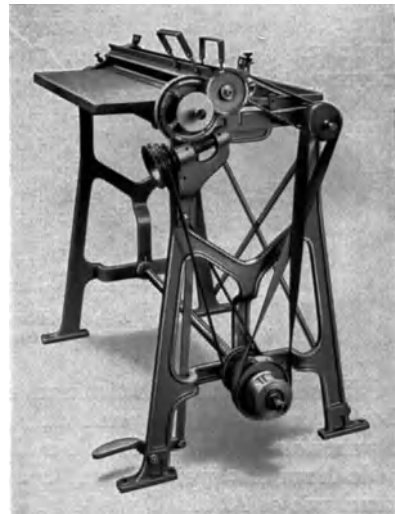
Abb. 211. Rauhmaschine mit animalischem Rauhorgan (DRP. 447 823). (Maschinenfabrik Arbach, G. m. b. H., Grözingen, Reutlingen.)
