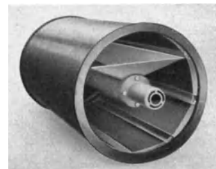
Abb. 266. Dekatierzylinder mit Kondenswasserabführung. (Ernst Gessner, A.G., Aue.)
