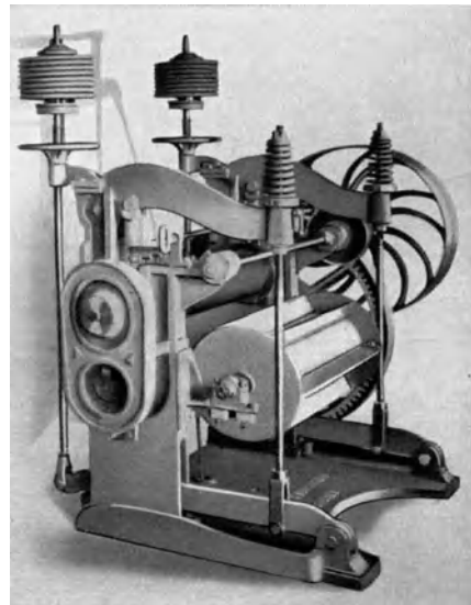
Abb. 109. Walzenquetsche für Wolle mit Auswurfvorrichtung. (Petrie & McNaught, Rochdale.)
