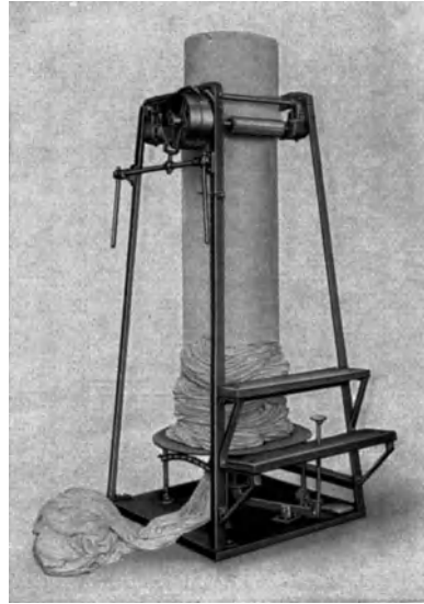
Abb. 235. Automatische Umkehrmaschine für rundgewirkte Stoffe. (Maschinenfabrik Arbach, G. m. b. H., Reutlingen.)
