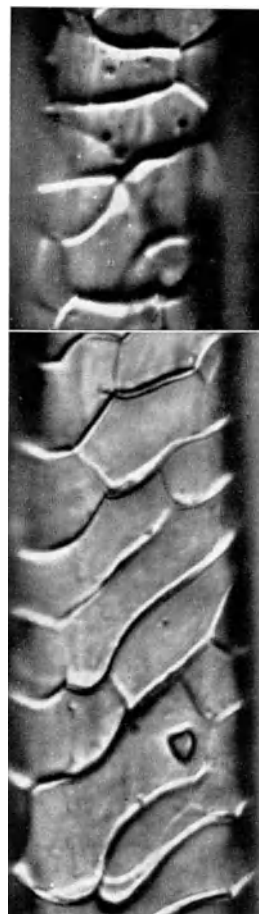
Abb. 22. Wollhaar, starke Schuppensperrung durch Säurebehandlung, R-O-X-Verfahren. Vergr. 560:1.
