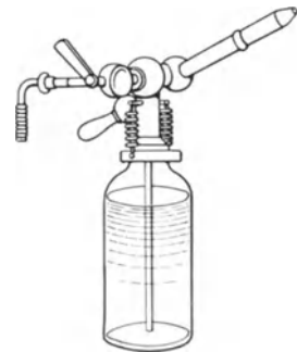
Abb. 33. SCHNITZLER-Apparat an Abb. 31 anzuschließen f. feuchten Spray mit kräftiger mechanischer Wirkung.
