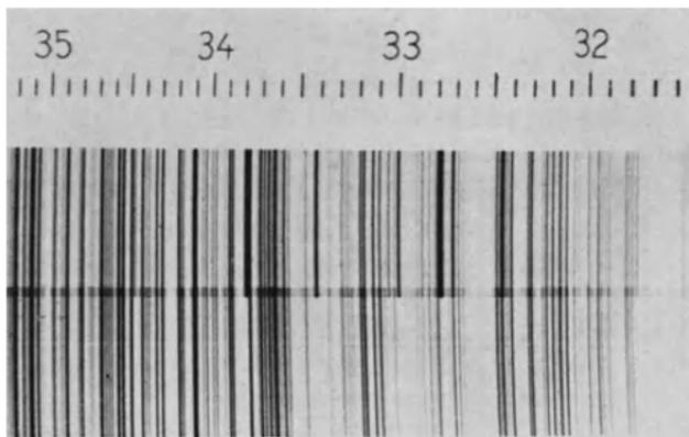
Abb. 49. Lötstelle Nickel.
