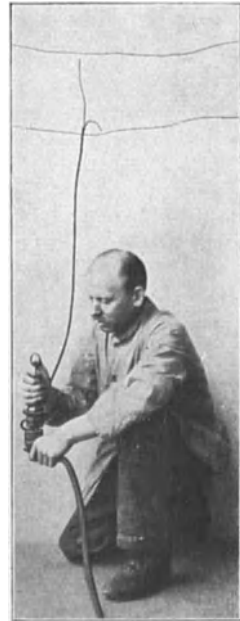
Abb. 70. Handhabung des Schießschalters mit Winkelstecker.
