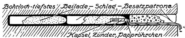
Abb. 41. Elektrische Zündung vom Bohrlochmunde.
