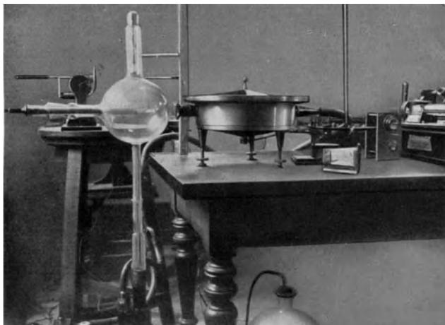
Abb. 102. Erster Vakuumspektrograph mit großem Glasröntgenrohr vom Verfasser [1916: 31].
