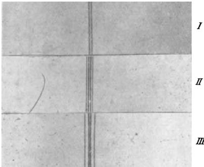
Abb. 108a. Aufnahme der Cu  $K\alpha$ -Dublette in erster, zweiter und dritter Ordnung mit Spektrometer Abb. 105 und Kalkspat als Gitter.
