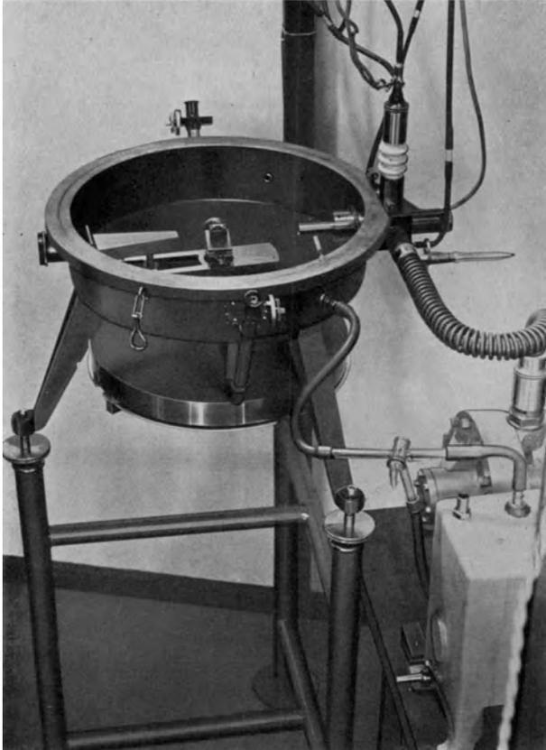
Abb. 105b. Ansicht eines Vakuumspektrographen in neuerer Ausführung.
