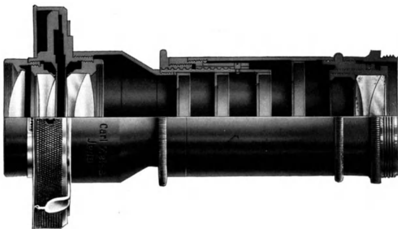
Abb. 313. Zusammengesetztes Teleobjektiv. Das photographische Objektiv ist im Verschuß gefaßt. Scharfeinstellung und Veränderung der Brennweite wird durch Veränderung der Tubuslänge bewirkt.
